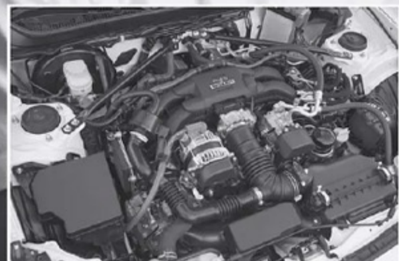
世界初「水平対向・D-4S」パワーユニットを搭載する200馬力。現在207馬力までアップ
