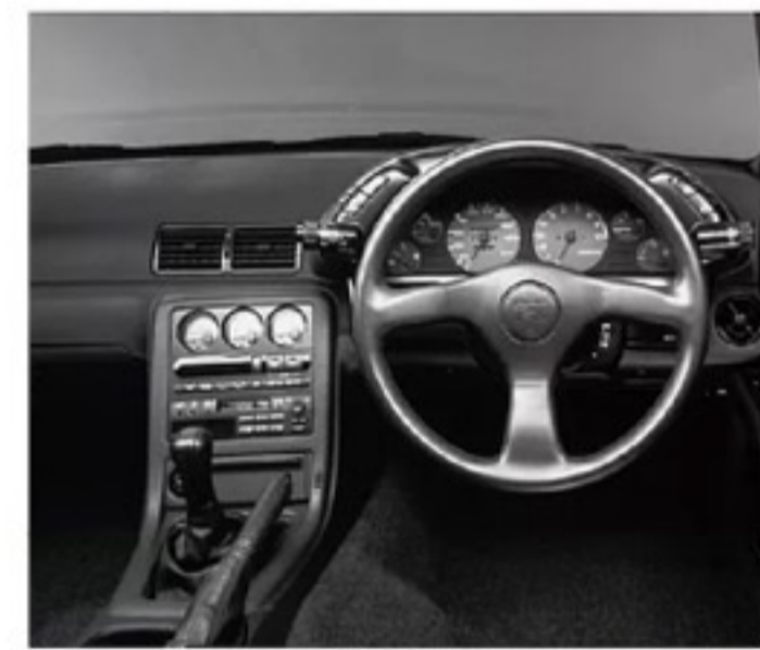
本革巻きステアリング&シフトノブを採用。ブースト計、電圧計、油温計の3連サブメーターは専用装備だった
