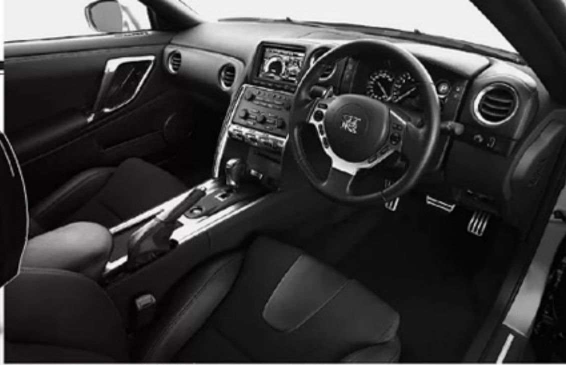
ナビ画面には、走行性能に関する各種のインフォメーションを表示できる。エンジン水温、油温、ターボのブースト圧、さらには前後左右の加速度まで表示される
